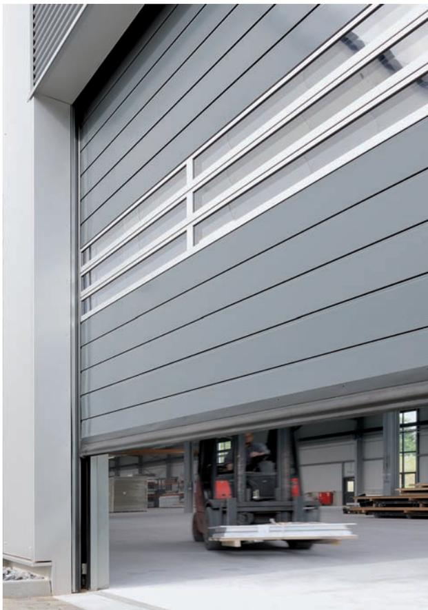
La porte rapide à enroulement spirale HS 7030 PU d'Hörmann s'adapte à toutes les exigences et aux contraintes des professionnels. Équipée d'un système de barrières photoélectriques de sécurité, la porte HS 7030 PU, rapide comme l'éclair (jusqu'à 2,5 m par seconde en ouverture et 0,5 m/ seconde en fermeture), sécurise la zone de fermeture de manière optimale en combinant un système de coupure automatique sans contact avec un système anti-crash radiocommandé.
